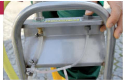
Durch Schließen des Zuluftlochs wird durch den entstehenden Unterdruck Reinigungsmittel angesaugt.
